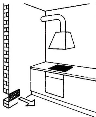
**COLLEGAMENTO ALL'ALIMENTAZIONE** - il collegamento dell'apparecchio alla tubazione o alla bombola del gas dovrà essere effettuato come prescritto dalle Norme UNI-CIG 7129 e 7131, solo dopo essersi accertati che esso è regolato per il tipo di gas con cui sarà alimentato. In caso contrario eseguire le operazioni indicate nel paragrafo "Cambio di gas" pagina 38. Nel caso di alimentazione con gas liquido, da bombola, utilizzare regolatori di pressione conformi alla Norme UNI-CIG 7432.
