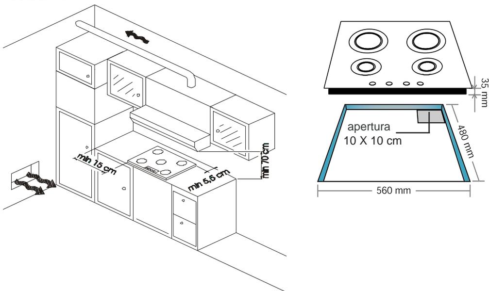
Il fondo del piano é equipaggiato di 4 alloggiamenti per le squadrette di fissaggio che bloccano il piano al mobile. Posizionare le 4 squadrette in modo tale che il piano sia perfettamente posizionato sul mobile.
