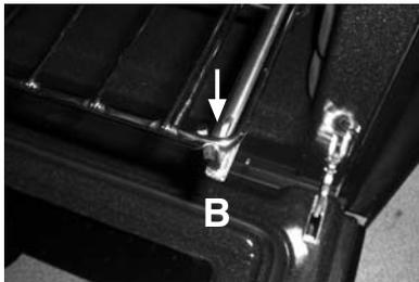
SLIDE OUT THE RUNNERS AND POSITION THE SHELF SUPPORT **B** BEHIND THE SHELF STOP LOCATED AT THE FRONT SIDE OF THE KIT.
