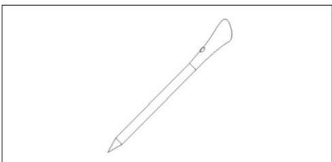
Misura la temperatura interna degli alimenti durante la cottura. Inserire nel foro sulla parte superiore della cavità. L'inserimento deve avvenire quando il forno è freddo.
