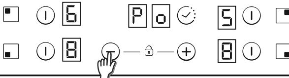
5 - Pomocí tlačítek „Plus“ a „Mínus“ lze upravovat hodnotu řízení výkonu. V tomto příkladu se jedná o hodnotu mezi 6500 a 2500 W. Až vyberete požadovanou hodnotu, na 5 sekund současně stiskněte tlačítka „Plus“ a „Mínus“.
