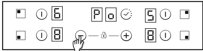
5 - Utilizzando i tasti più (+) e meno (-) del timer, è possibile regolare il valore di gestione della potenza, che in questo esempio è compresa tra 6500 W e 2500 W. Quando viene selezionato il valore richiesto, toccare contemporaneamente i tasti più (+) e meno (-) del timer per 5 secondi.
