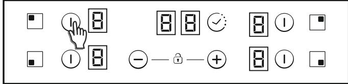
Per accendere una zona di riscaldamento toccare una qualsiasi zona di riscaldamento per 400 msec. Si sentirà un bip prolungato ed il valore "0" verrà visualizzato nella cifra della zona di destinazione, indicando il livello di potenza.
