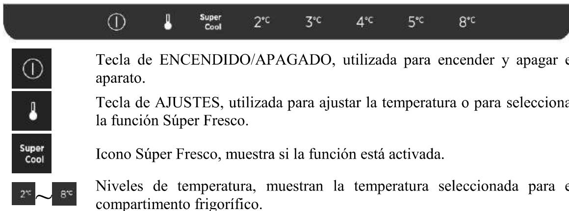
Tecla de ENCENDIDO/APAGADO, utilizada para encender y apagar el aparato.
