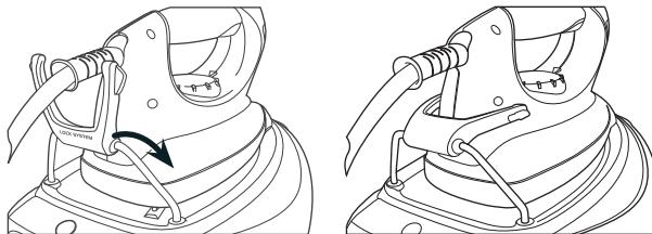
fig. 8: Système de blocage du fer professionnel
