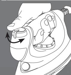
Per ottenere i migliori risultati, è davvero importante impostare la corretta temperatura della piastra e del getto di vapore che si utilizza. Il vostro apparecchio Hoover dispone di un esclusivo selettore Multi Steam Technology (14), se correttamente utilizzato, semplifica la stiratura garantendo risultati eccezionali e rendendola più agevole e rapida.
