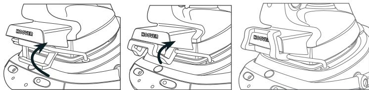
fig. 7: Sistema de bloqueo de la plancha doméstica
