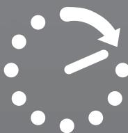
A luz "Desligar automático" (1C) está acesa: Após 10 minutos de inactividade de vapor, a caldeira e o ferro começam a arrefecer. Para tornar a engomar, desligue e volte a ligar o interruptor principal (1A). Terá de aguardar um pouco até que o vapor esteja pronto para recomeçar a engomar. Consulte o parágrafo sobre o indicador luminoso vapor pronto para mais informações. (apenas os modelos: SRD 4108, SRD 4110)
