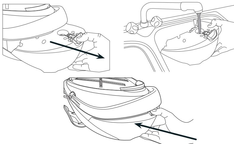
fig. 10: Imagen del llenado del depósito del agua
