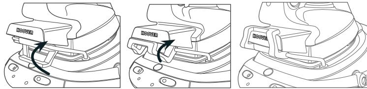
fig. 7: Sistema de bloqueio do ferro doméstico
