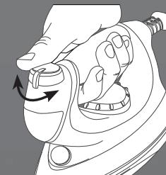
Um beste Ergebnisse zu erreichen, ist es wichtig, dass Sie die Temperatur der Bodenplatte und den Dampf entsprechend der Verwendung genau einstellen. Ihr Hoover-Gerät besitzt einen spezifischen Wahlschalter für die MultiSteam Technology (14). Bei richtiger Anwendung erleichtert dieser Wahlschalter das Bügeln und sorgt für hervorragende Ergebnisse, sodass das Bügeln leichter und schneller geht.
