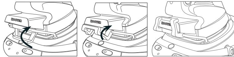
fig. 7: Système de blocage du fer domestique
