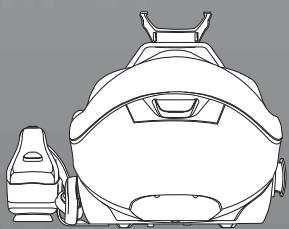
Per il modello SRD 41110, collocare la spazzola a vapore sull'apposito supporto e il cavo elettrico nell'apposito vano riponi-cavi.
