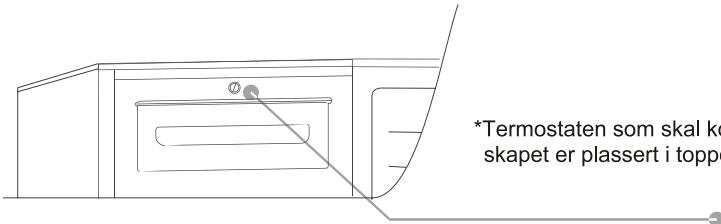
\*Termostaten som skal kontrollere skapet er plassert i toppdekselet på skapet.
