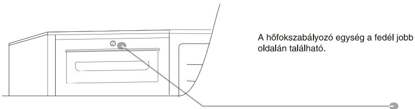
A hőfokszabályozó egység a fedél jobb oldalán található.
