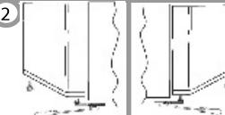
Verwijder de twee schroefkappen aan de bovenzijde van de deur en draai de schroeven los.
