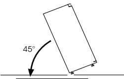
Снимите нижнюю петлю двери. Для этого выверните винты, и снимите колпачок и шайбы, а затем снимите дверь холодильника.
