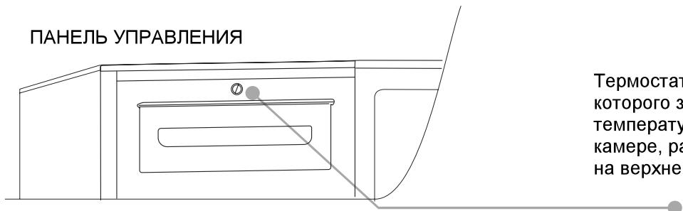
Термостат, с помощью которого задается нужная температура в морозильной камере, расположен справа на верхней крышке.
