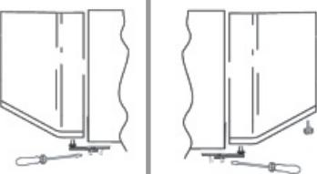
Снимите два расположенных сверху колпачка, которыми зарыты винты, и выверните два винта
